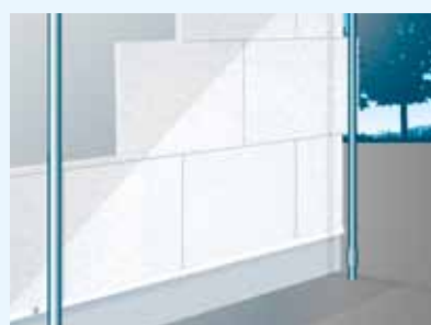
Fig. 4 : Pose des panneaux, façon "joint de pierre"
