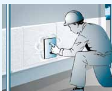
Fig. 5 : Les panneaux sont frappés et pressés à l'aide d'un bouclier
